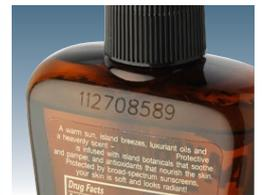
直接打印在喷雾瓶上的激光编码
